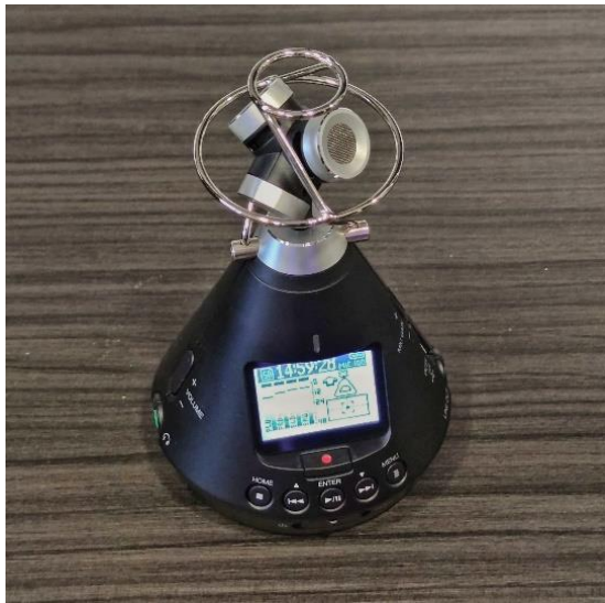
Figura 74 Microfon ambisonic (stânga), poziționarea tetraedrică a microfoanelor (dreapta)
