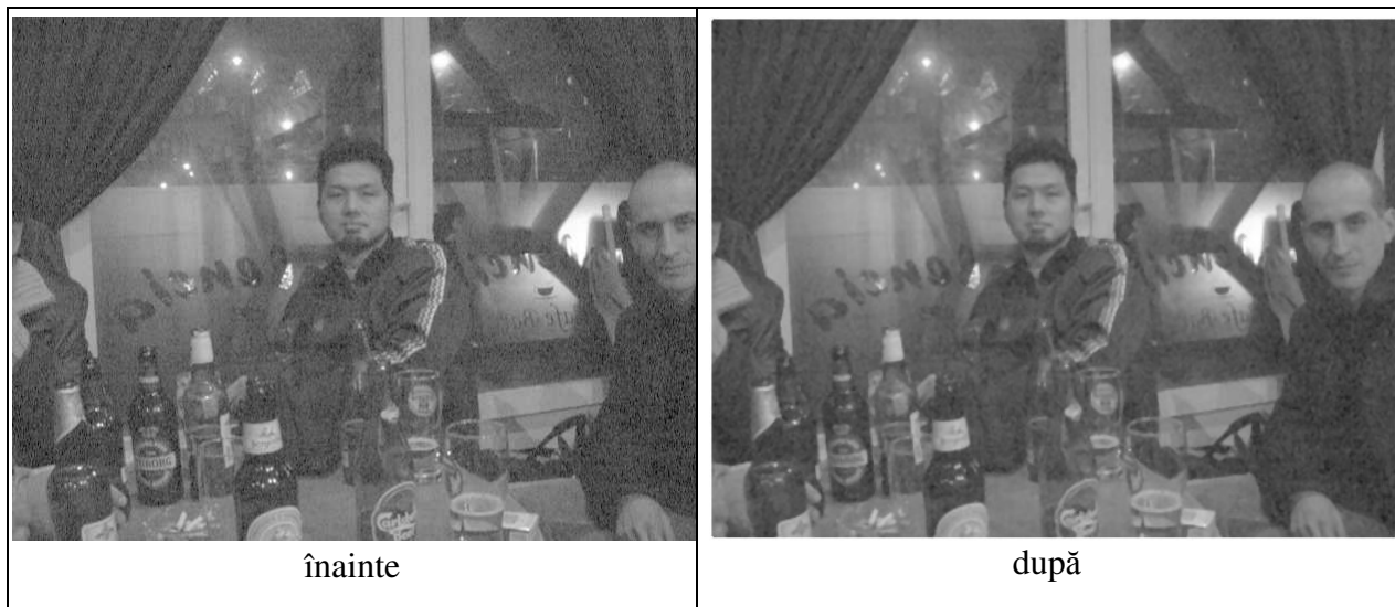
Fig. IV.3.3_1 Înainte și după eliminarea zgomotelor pentru imaginea ‘preview’ în scară de gri (luminanță). Deși avem o dimensiune mică a imaginii, se observă eliminarea zgomotului.
