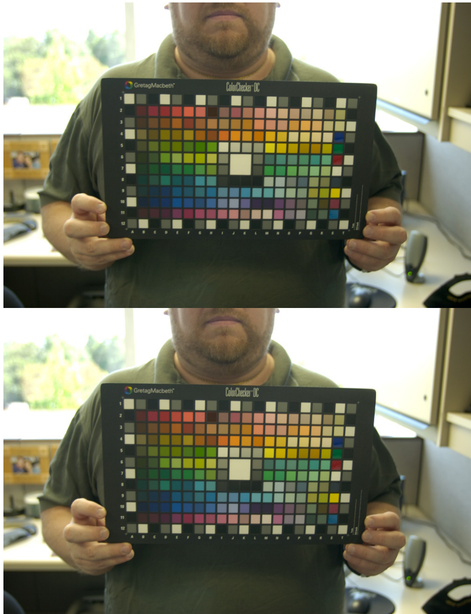
Fig. IV.1.3_1 și IV.1.3_2: prima imagine corespunde unei conversii Adobe RGB → sRGB cu logaritm (metoda noastră), următoarea corespunde aceleiași conversii cu metoda clasică (interpolare liniară)
