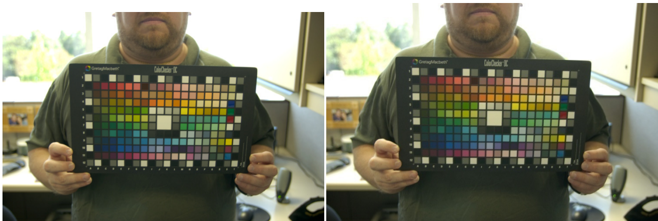
Fig. IV.1.3_1 și IV.1.3_2: prima imagine corespunde unei conversii Adobe RGB → sRGB cu logaritm (metoda noastră), următoarea corespunde aceleiași conversii cu metoda clasică (interpolare liniară)
